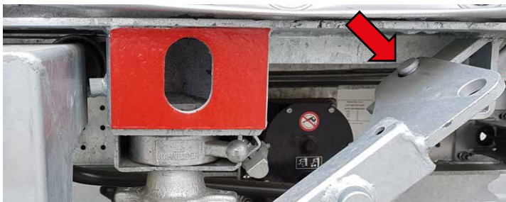
Fotografie 84c Správně upevněná vzpěra
